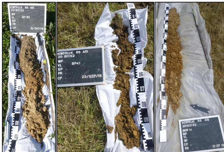
Figuur 60: Foto's van de typeprofielboringen, boring 53, boring 41 en boring 14 (ABO nv 2018)
