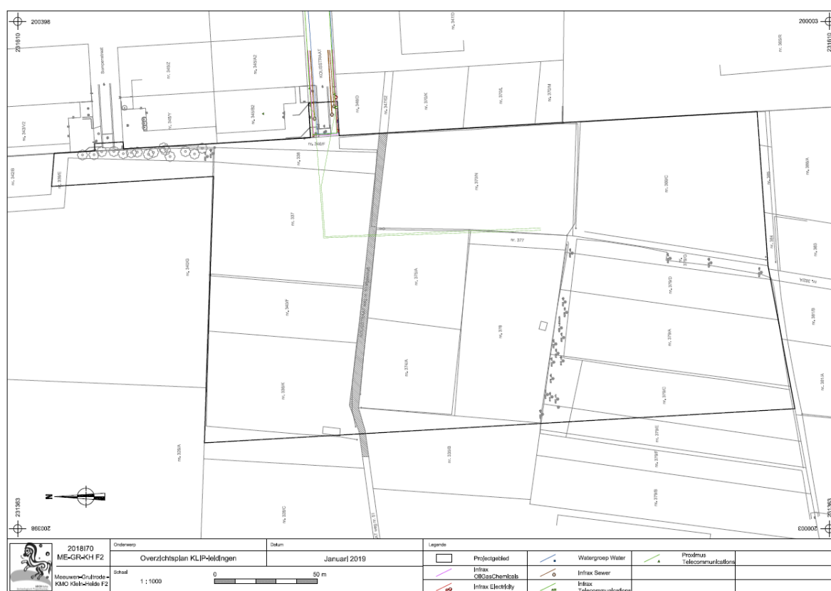
Afb. 25: Overzicht aanwezige nutsleidingen op het onderzoeksterrein (Bron: KLIP, digitaal plan, dd 15/01/2019, aanmaatschaal 1.1000, 2018/70).
