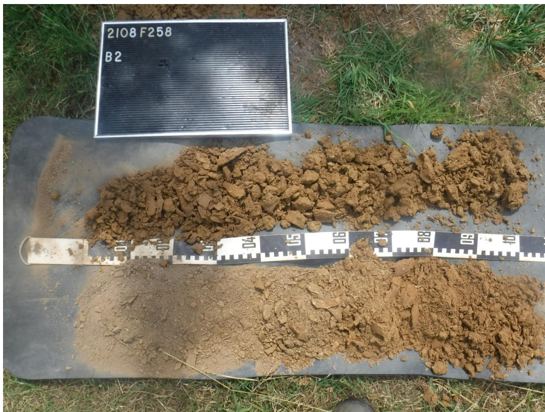
Afb. 19. Boring 2 (uitgelegd van links naar rechts: 0-100 cm (onder) en 100 – 200(boven)).
