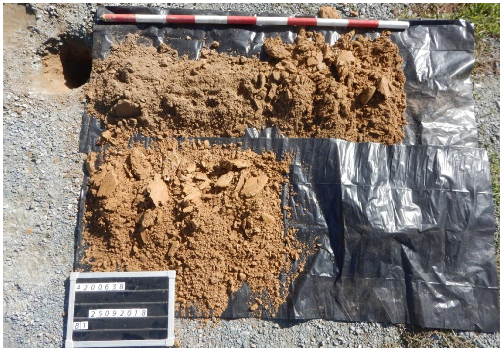
Afb. 22. Boring 1, intacte textuur-B bodem met een A-AE-Bt profielopbouw in leem (löss).
