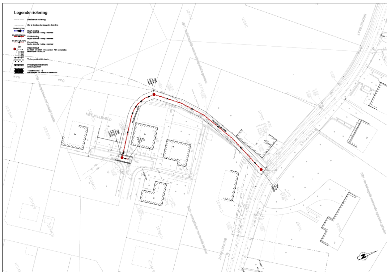
Figuur 56: Ontworpen toestand van zone 11 (DWA), detail uit bijlage (bron: Sweco)
