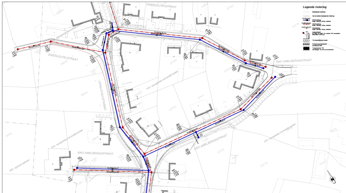
Figuur 23: Ontworpen toestand van zone 3 (DWA, RWA), detail uit bijlage (bron: Sweco)
