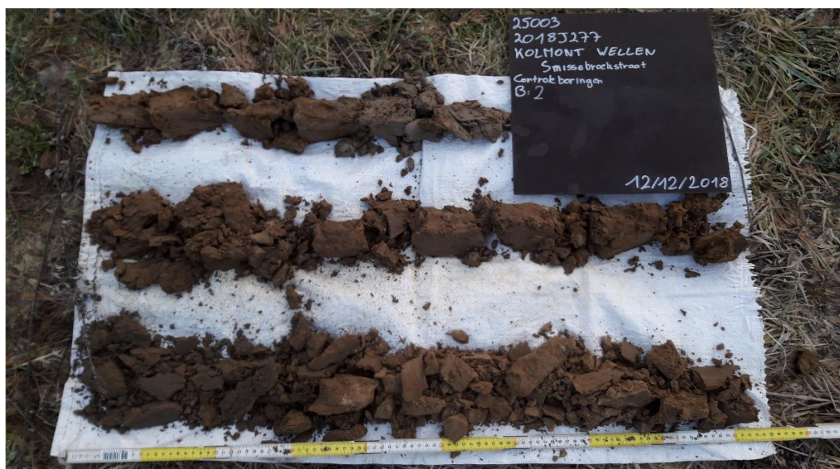
Figuur 18: Boorprofiel van boring 2 (ABO nv 2018)
