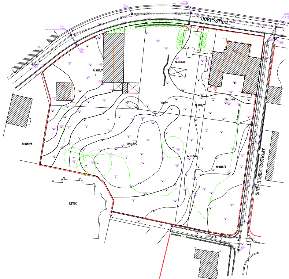
Niveaumetingen terrein aangevuld met isohypsen
