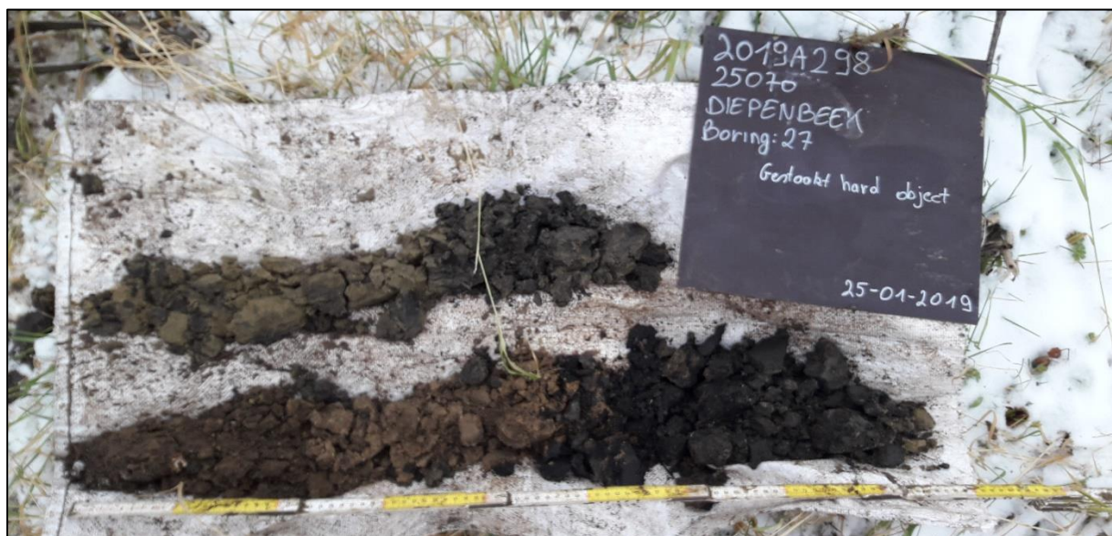
Figuur 22: Boorprofiel van boring 27 (ABO nv 2019)
