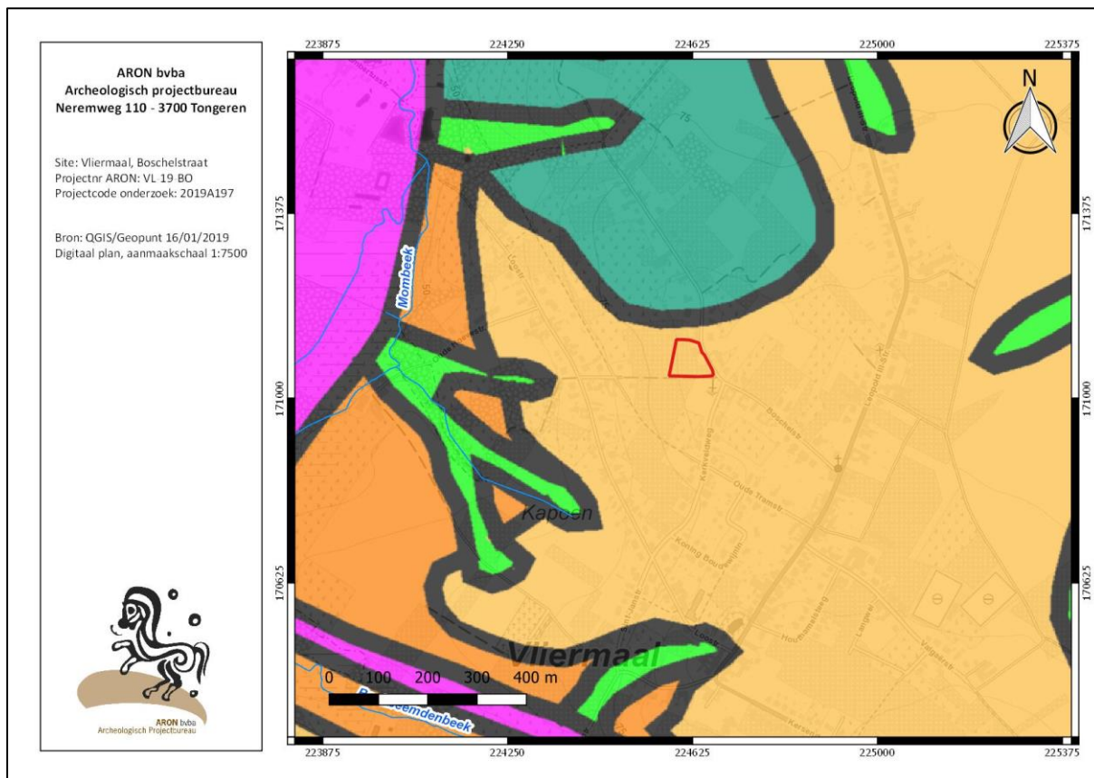
Afb. 13: Uittreksel Quartair profieltypekaart kaartblad 33 Sint-Truiden met afbakening van het onderzoeksterrein in het rood (Geel: dik pakket Brabant Leem op dun pakket Haspengouw Leem, Oranje: dun pakket Brabant Leem op dik pakket Haspengouw Leem Donkergroen: zandleemafzettingen.; Lichtgroen: Colluvium en Paars: Beekalluvium) (Uittreksels uit Cartoweb.be met toelating van het Nationaal Geografisch Instituut C18008 – www.ngi.be ).
