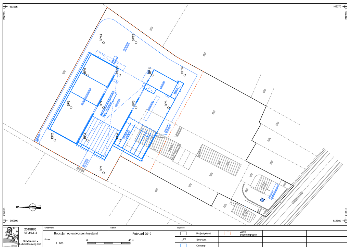
Afb. 32: Boorplan met aanduiding van de boorpunten en het projectgebied (zwart), de zone voor vervolgonderzoek (oranje) op ontworpen toestand (blauw, OT) ((Bron: Aron bvba, digitaal plan, dd. 13/02/2019, aanmaatschaal 1.800, 2019B65).
