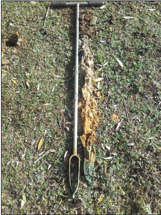
Figuur 13. Boring 9 met (waarschijnlijk verplaatst) blauwgrijs Tertiair zand onderin.
