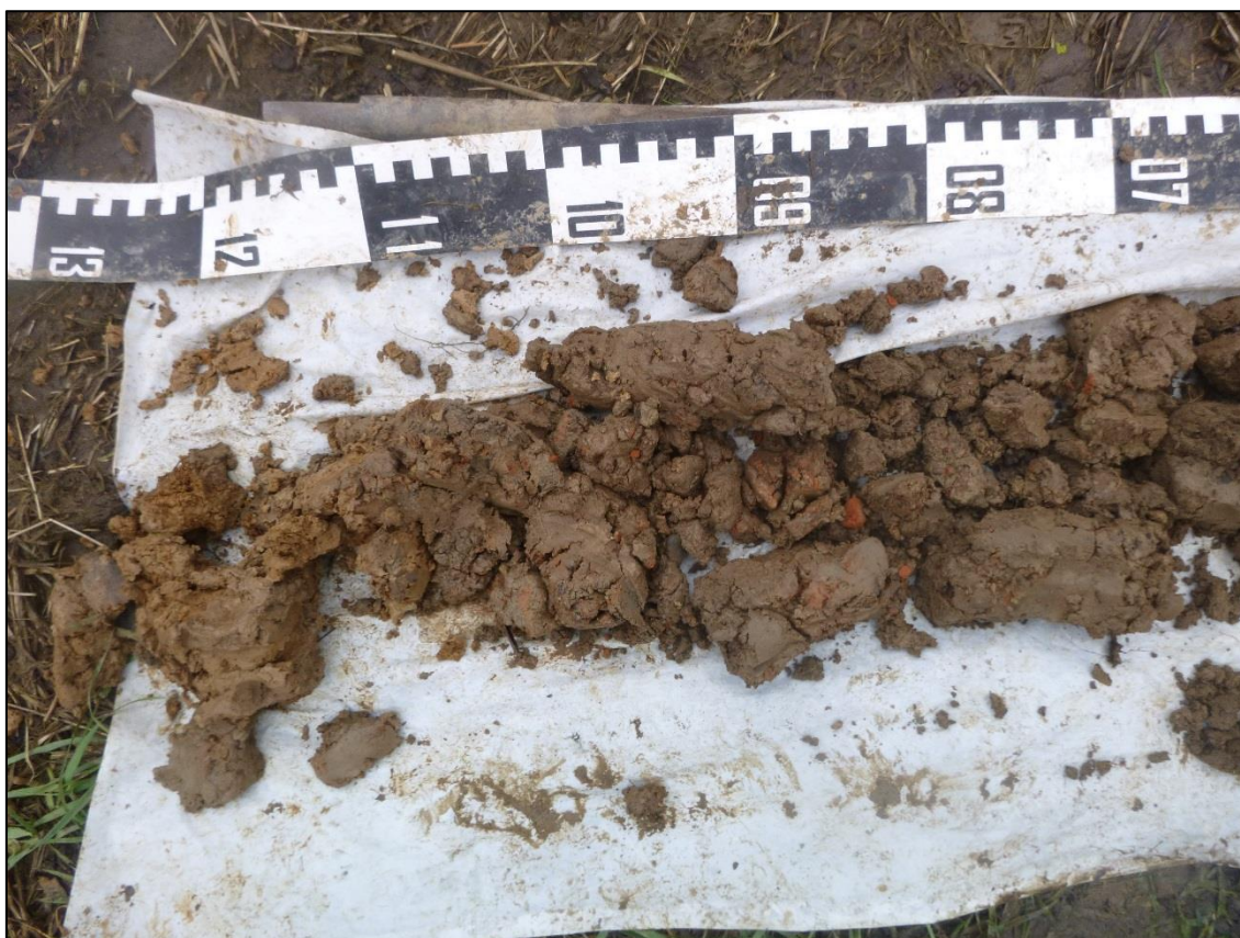
Figuur 37: Foto van sterk puinhoudende laag met veel baksteenresten net boven de C-horizont (ABO nv 2019)
