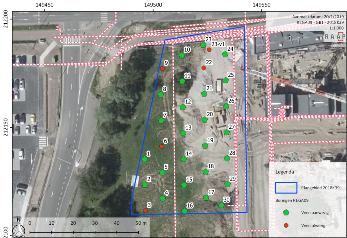
figuur 4: Overzicht van de resultaten van de verkennende boringen ten aanzien van het aantreffen van veen. In boringen 6, 9 en 23-v1 werden veenbrokken aangetroffen boven het dekzand, terwijl boringen 3 en 22 enkel opgebracht materiaal opleverden boven het dekzandniveau. Het dekzand in boring 22 was vermoedelijk volledig intact, omdat het grijze niveau intact was. In boring 3 kon deze vaststelling niet worden gedaan (bron achtergrond: AGIV, 2018b).
