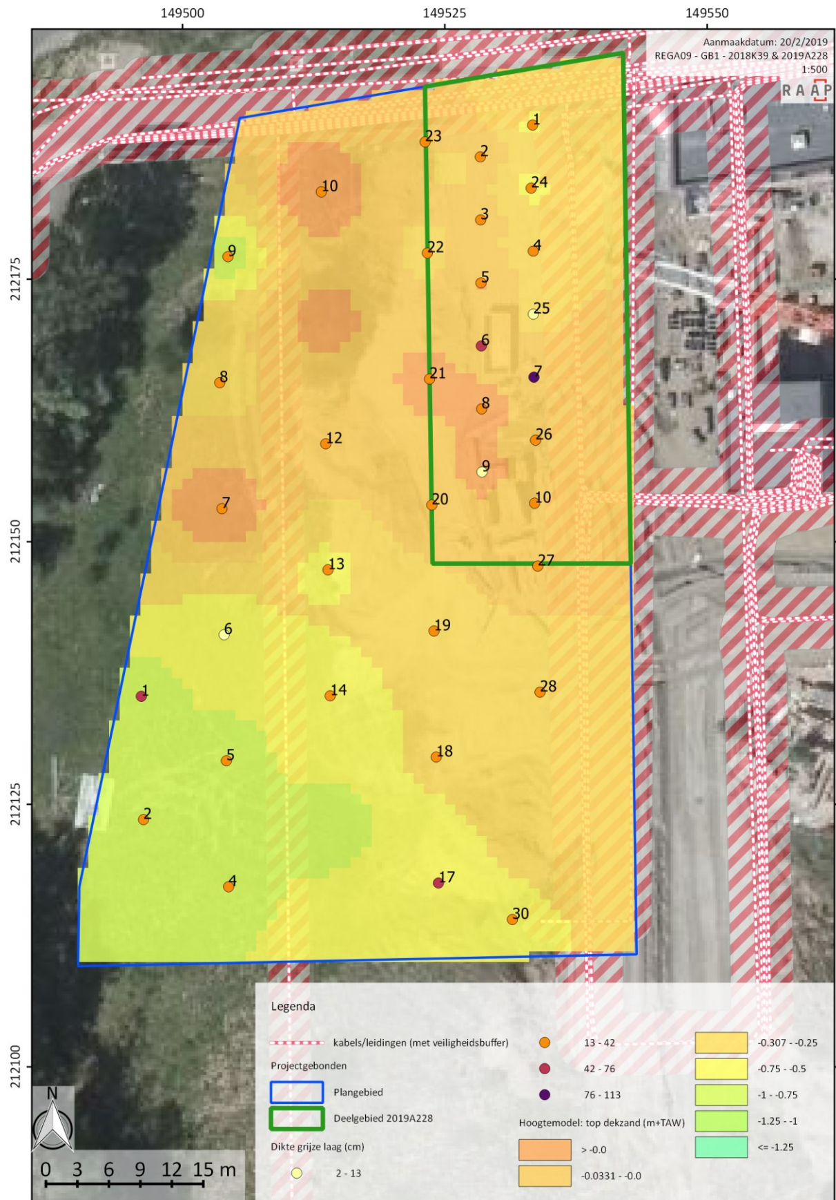
figuur 12: Resultaten van het verkennende en waarderende booronderzoek gecombineerd tot één figuur/ model (bron achtergrond: AGIV, 2018b).
