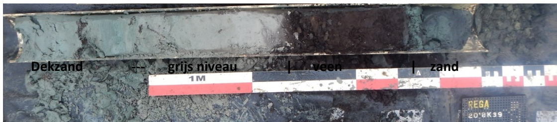
figuur 3: Foto van het bovengehaalde deel van boring 28 met aanduidingen van de onderscheiden bodemkundige eenheden.
