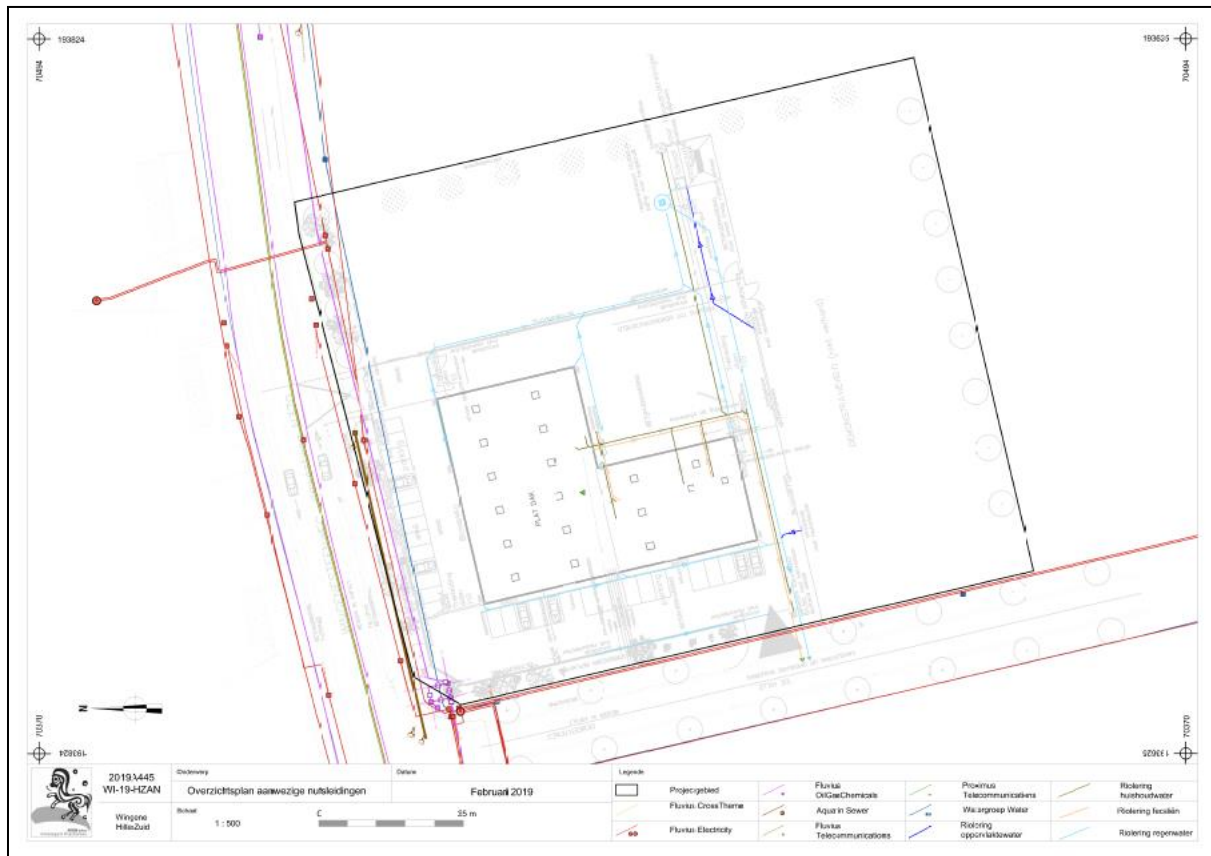
Afb. 27: Overzicht aanwezige nutsleidingen op het onderzoeksterrein (Bron: KLIP, digitaal plan, dd 28/01/2019, aanmaatschaal 1.500, 2019A445).
