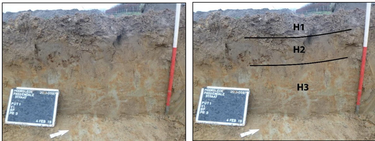
Figuur 99: Referentieprofiel 1.3 (links); met aanduiding horizonten (rechts).
