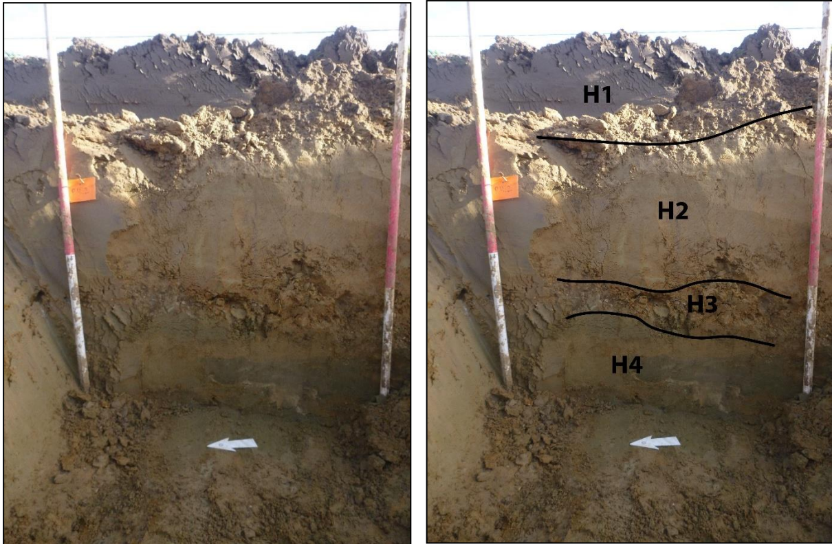
Figuur 102: Referentieprofiel 4.2 (links); met aanduiding horizonten (rechts).
