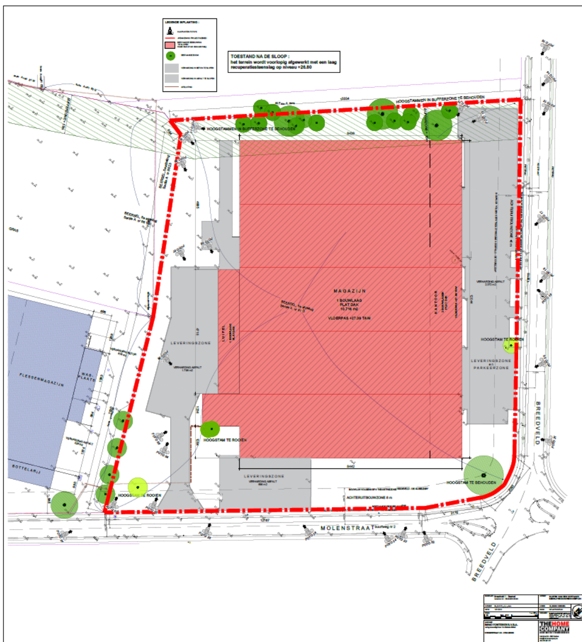
Figuur 5: Sloop van de bestaande gebouwen en verhardingen (Bron: The Home Company Architectenbureau).
