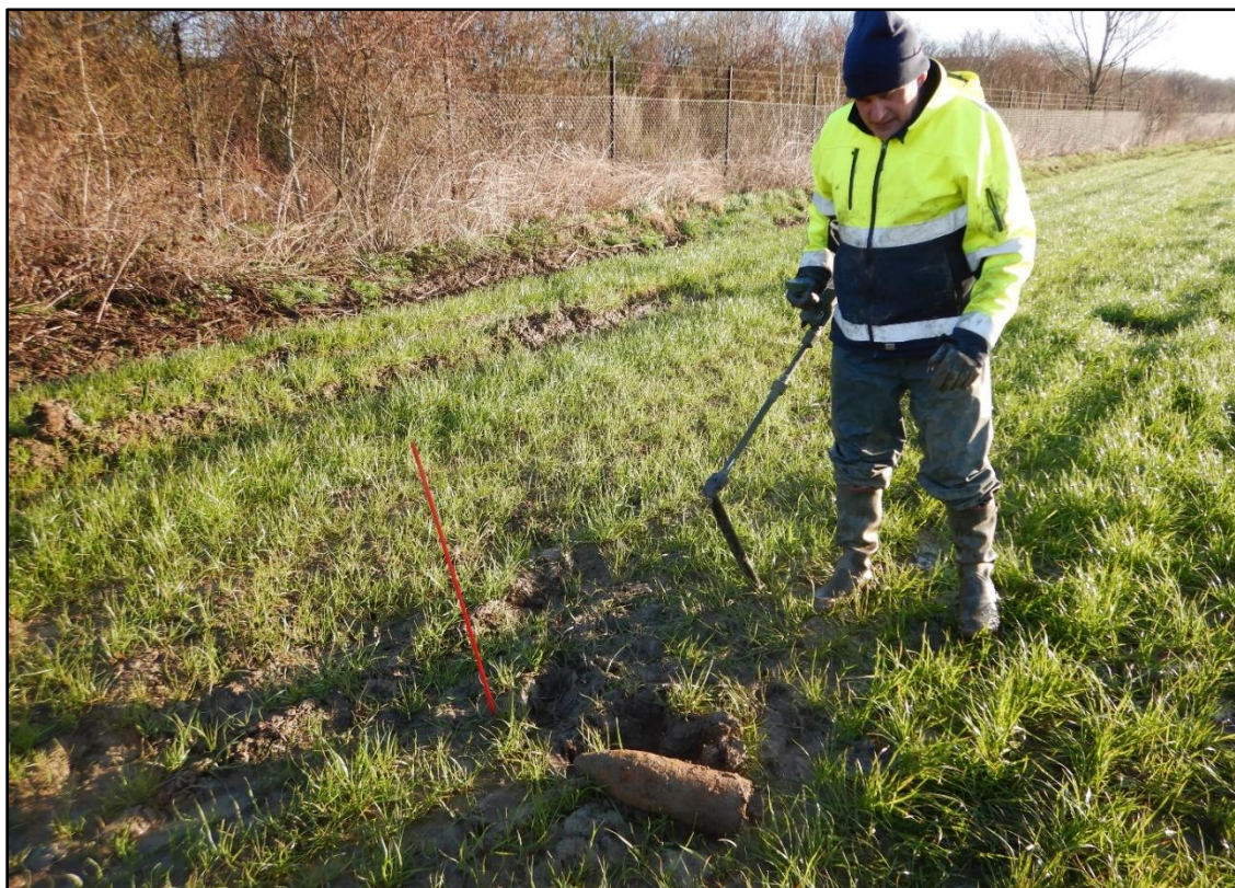
Figuur 30 Net onder het oppervlak liggende Britse 4,5inch, gemarkeerd als potentieel explosief na het geofysisch onderzoek.
