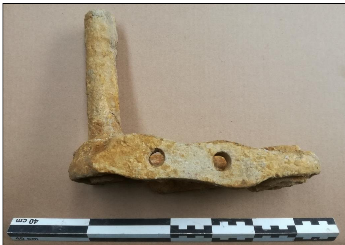
Figuur 26 Zijaanzicht op de ijzeren schakel van een 20 ste -eeuwse graafmachine (inv. 1).
