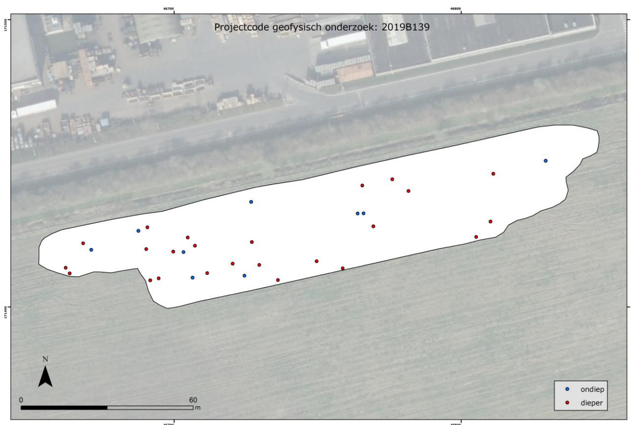
Figuur 16: Locaties van de ondiepe (0 – 0.4 m) en diepere (> 0.4 m) grotere of massieve metalen objecten.
