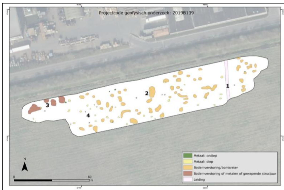
Figuur 10 Sporen met nummering van 4 afwijkende zones op basis van de EG en MG metingen.
