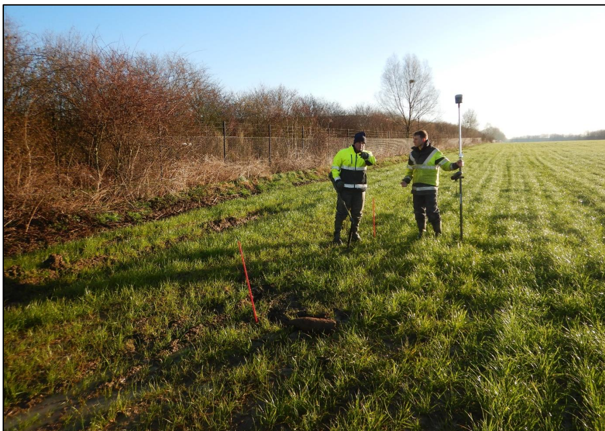
Figuur 6 Controle van de anomalieën door ontmijner met op de voorgrond een ondiep gelegen onafgevuurde Britse 4,5inch.
