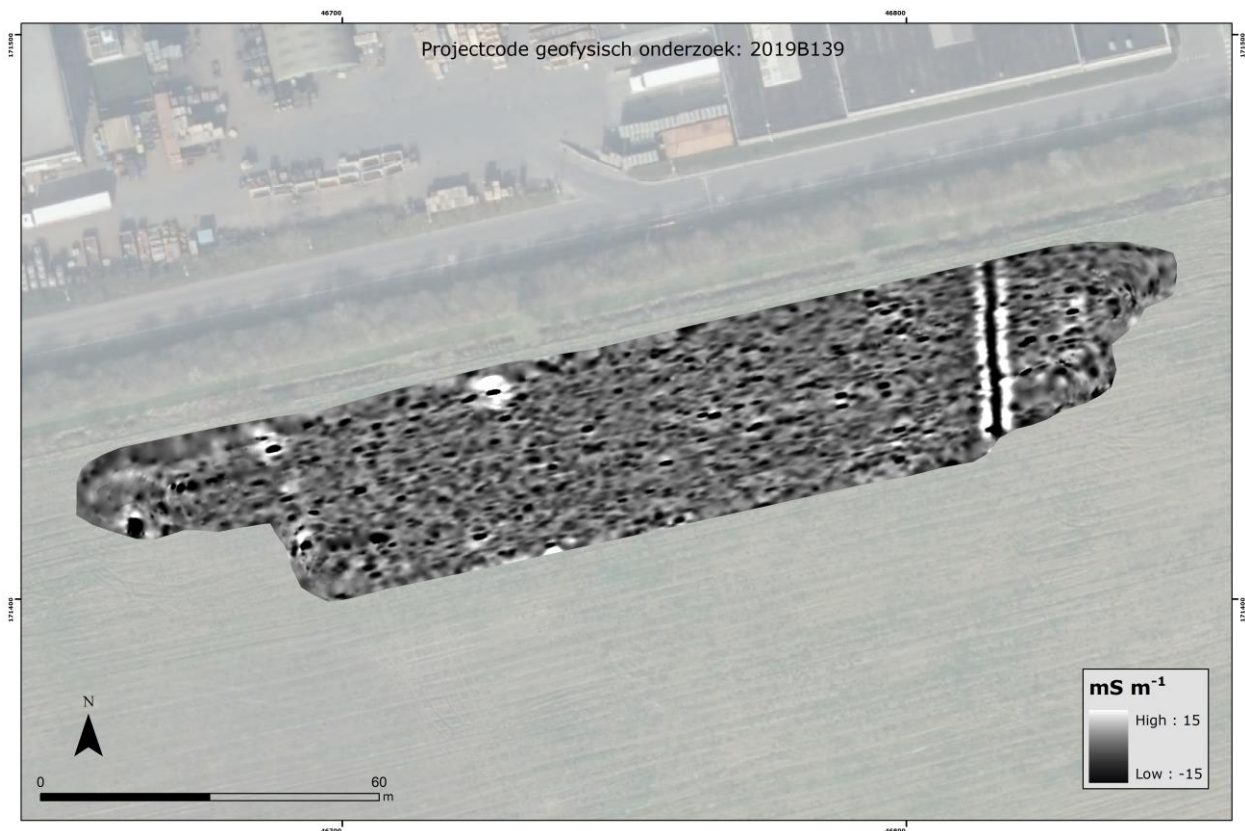
Figuur 8: Gefilterde EG opgemeten met de 1HCP spoelconfiguratie (dominante respons tussen 0 en 1.6 m diepte).
