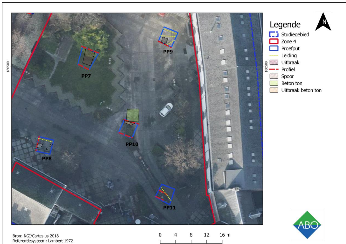
Figuur 40: Overzicht GPS opmetingen van proefputten 7 tot 11 (bron: ABO nv 2019)
