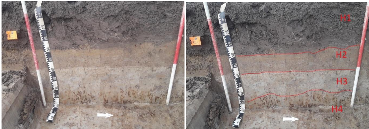
Figuur 2 : Profiel 2.1 (boven); met aanduiding horizonten (onder).
