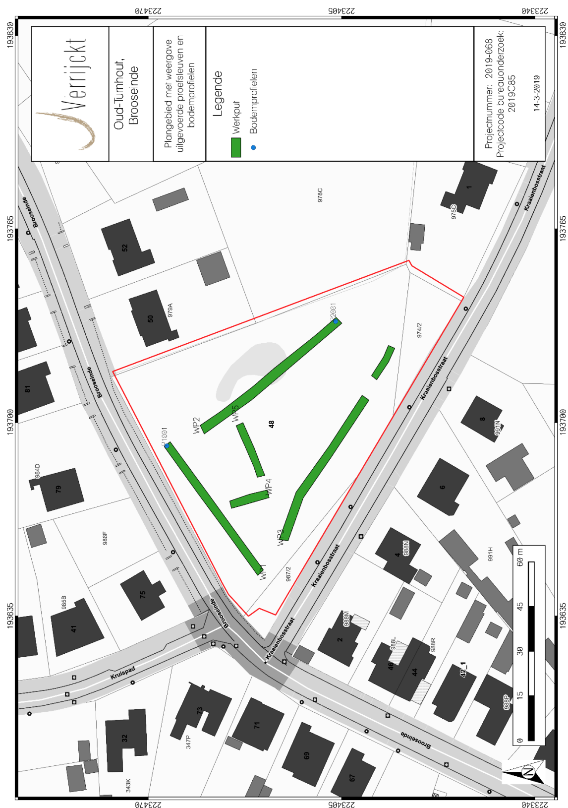
Figuur 17: Proefsleuvenplan met weergave bodemprofielen
