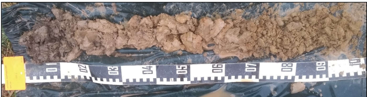
Figuur 16: Boring 4, van 0 cm (links) tot 100 cm (rechts).
