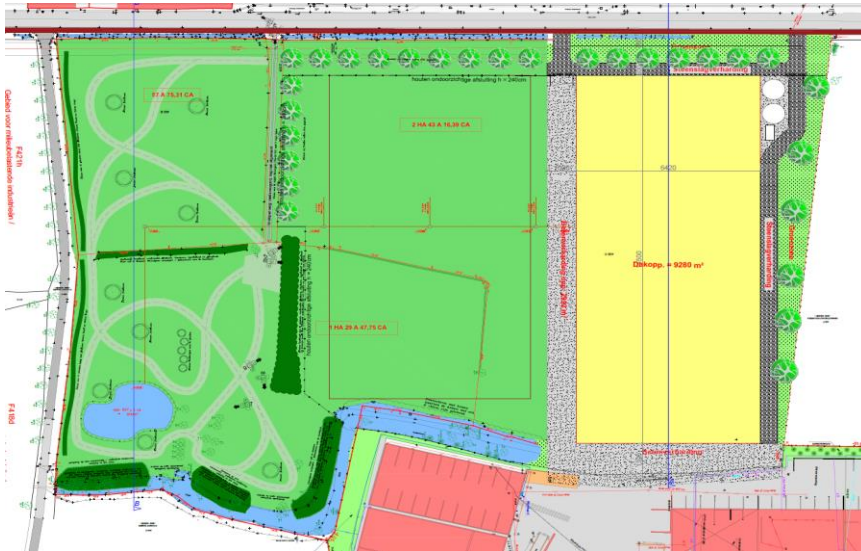
Figuur 5: Inplantingsplan van de geplande werkzaamheden. In het westen zal een bufferbekken worden aangelegd. Het rode kader geeft de zone weer waar de grond zal worden afgegraven. Hier worden twee loodsen en infrastructuurwerken voorzien. (bron: DBG Architecten, Galloo NV).
