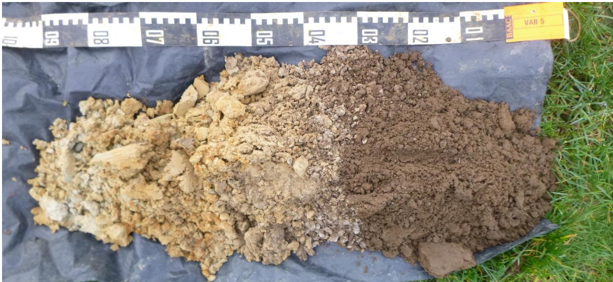
Figuur 19: VAB5 met een Ap-horizont (0-35 cm), een E-horizont (35-40 cm), een Cg-horizont (40-75 cm) en een C-horizont (75-90 cm)
