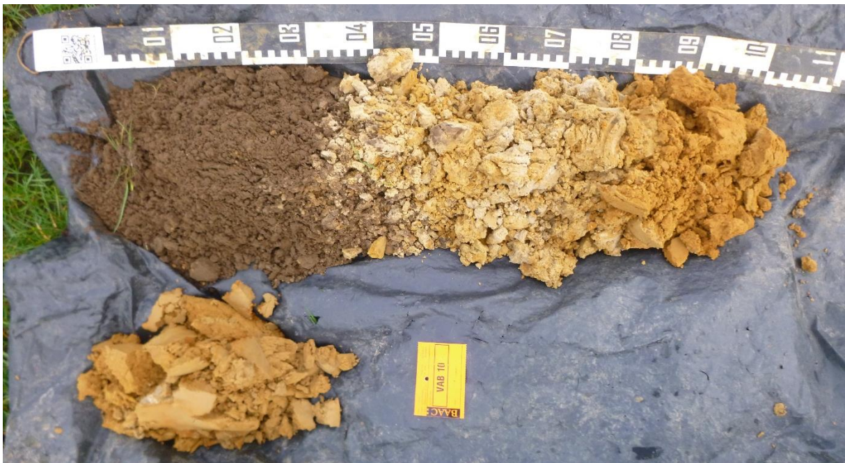
Figuur 20: VAB10 met een Ap-horizont (0-30 cm), een A/C-horizont (30-40 cm), een Cg-horizont (40-75 cm) en een C-horizont (75-120 cm)
