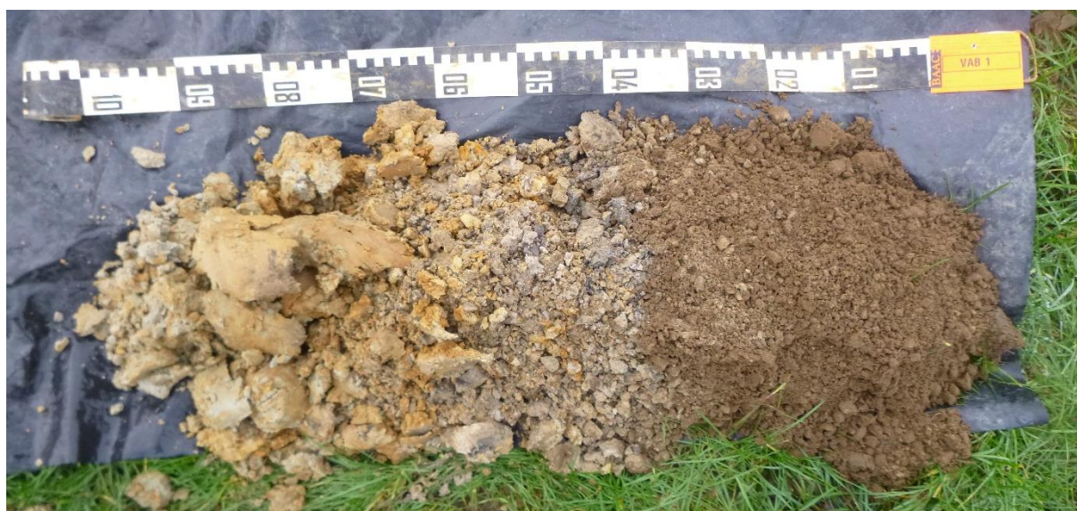
Figuur 18: VAB1 met een Ap-horizont (0-40 cm), een E-horizont (40-50 cm) en een Cg-horizont (50-100 cm)
