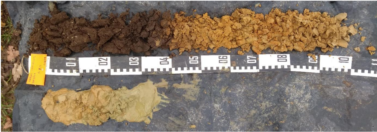
Figuur 7: Boring 3, van 0 cm (linksboven) tot 130 cm (rechtsonder).
