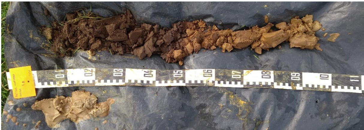
Figuur 13: Boring 9, van 0 cm (linksboven) tot 120 cm (rechtsonder).
