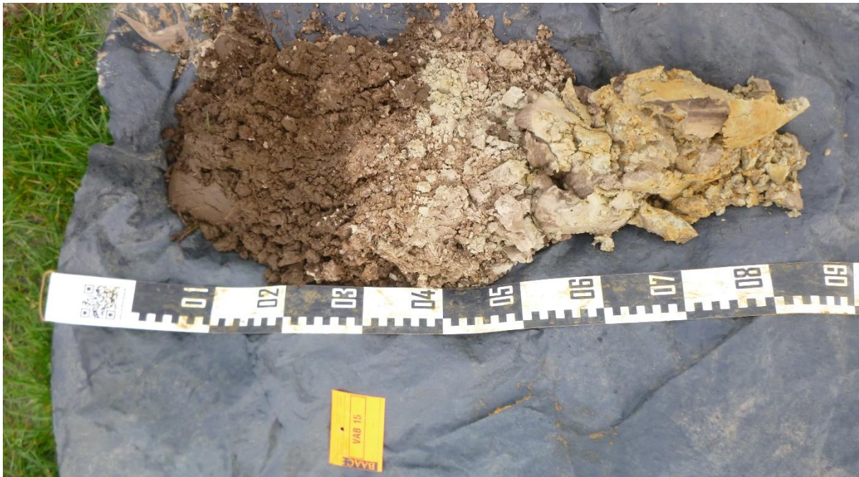
Figuur 21: VAB15 met een Ap-horizont (0-30 cm), een AE-horizont (30-35 cm), een E-horizont (35-50 cm) en een Cg-horizont (50-85 cm)
