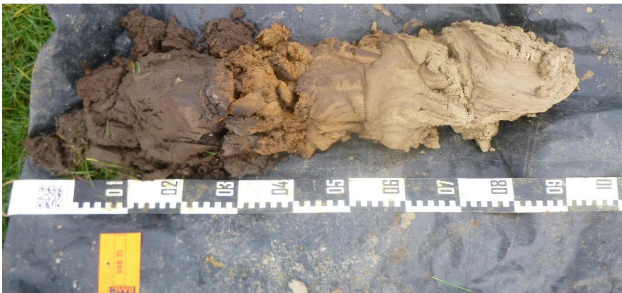
Figuur 22: VAB20 met een Ap-horizont (0-25 cm), een AE-horizont (25-30 cm), een EB-horizont (30-40 cm), Cg-horizont (40-55 cm) en een C-horizont (55-90 cm)
