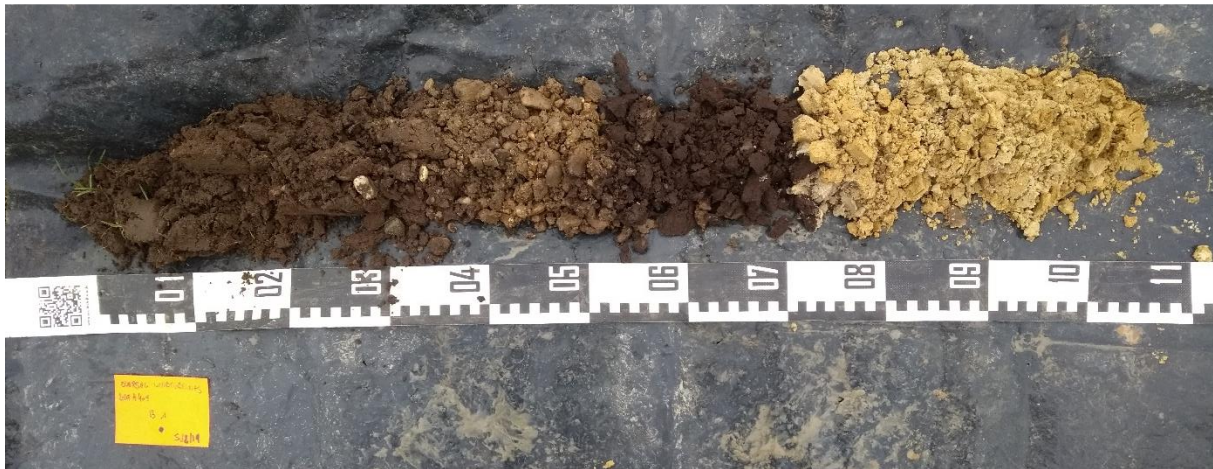
Figuur 5: Boring 1, van 0 cm (links) tot 105 cm (rechts).
