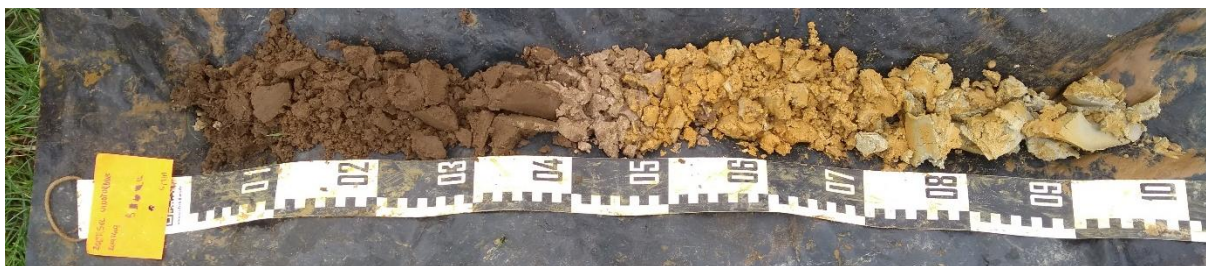
Figuur 17: Boring 13, van 0 cm (links) tot 100 cm (rechts).
