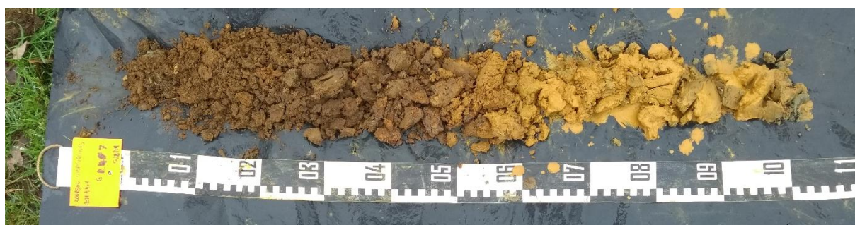
Figuur 11: Boring 7, van 0 cm (links) tot 100 cm (rechts).
