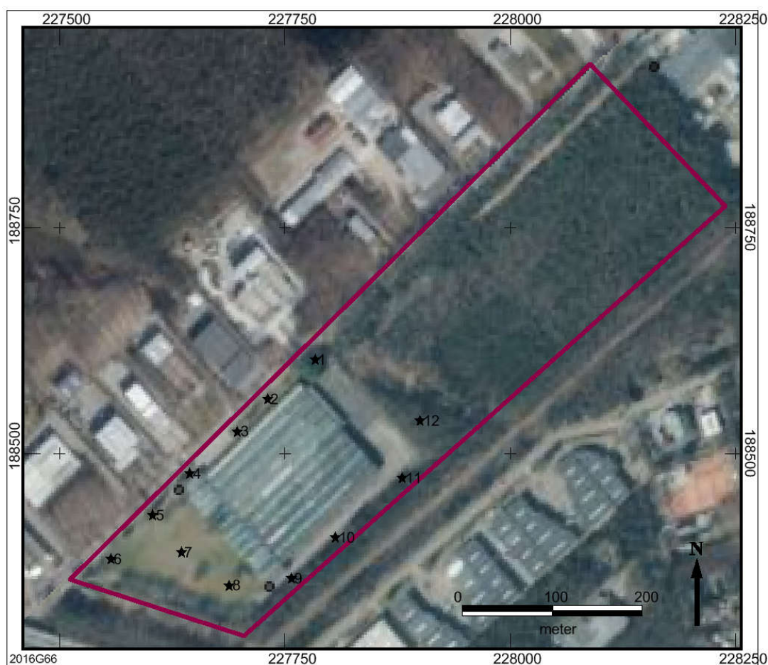
Afbeelding 18: boorpuntenkaart met de locaties van de boringen voor de landschappelijke boringen. 11 boringen zijn op het perceel van de industriële loods geplaatst, de 12 de boring situeert zich op het onverstoorde noordelijke deel.
