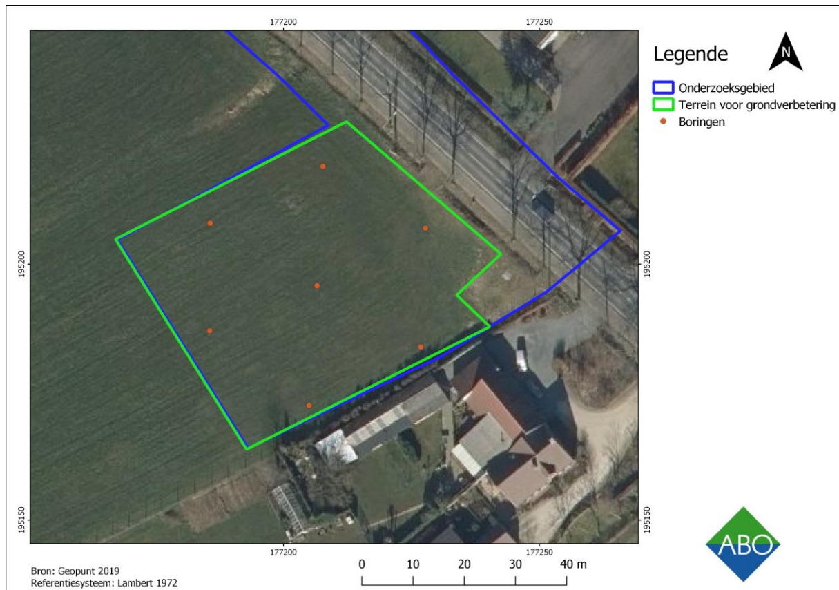
Figuur 3: ortholuchtfoto (2018) met aanduiding van de boorpunten voor het landschappelijk bodemonderzoek binnen het tijdelijke terrein voor grondverbetering (Geopunt 2019).
