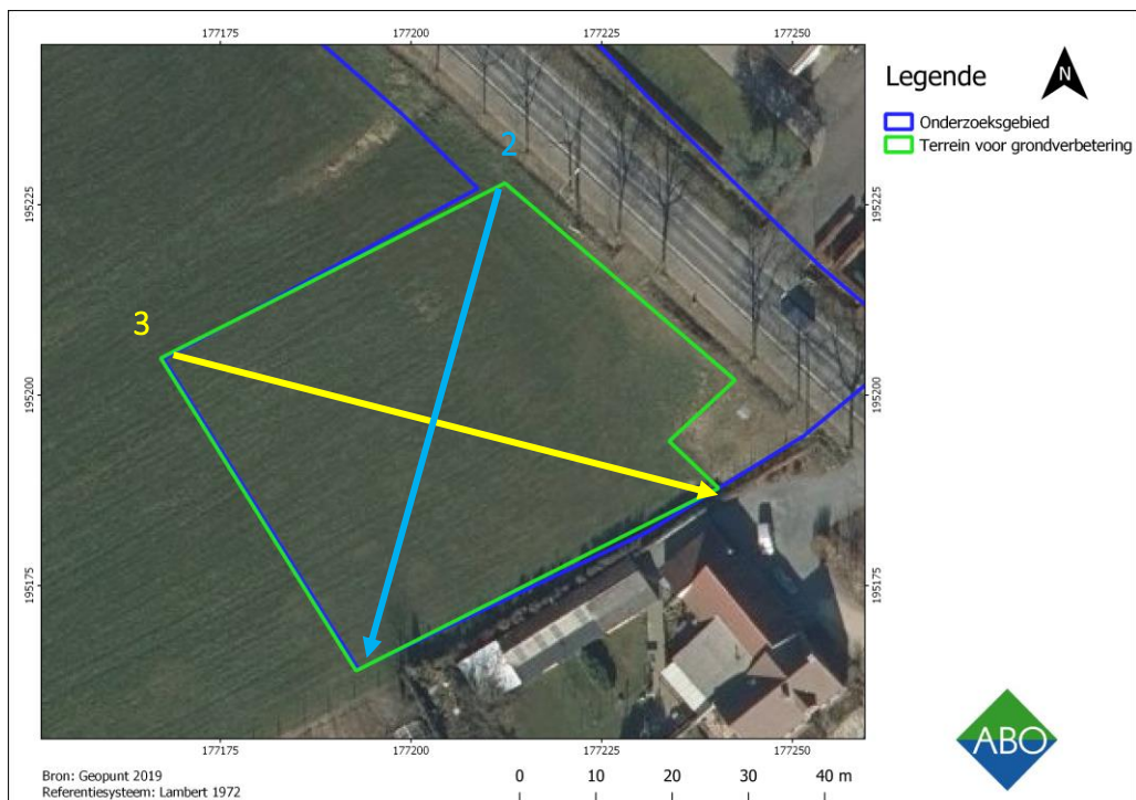
Figuur 14: Ortholuchtfoto (middenschallig, winteropname, 2018) met detail van het tijdelijke terrein voor grondverbetering. De nummers van de hoogteprofielen corresponderen met deze weergegeven in Figuur 15 (Geopunt 2019).
