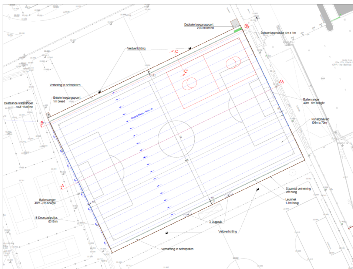
Figuur 8: Overzicht opbouw toekomstig voetbalveld met drainageleidingen 11
