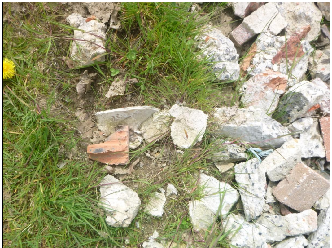
Afb. 16. Asbestfragmenten in het verharde pad.
