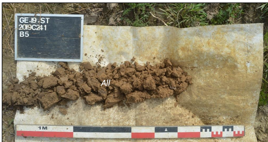
Afb. 30: Controleboring 5 met horizonten alluvium (Aron bvba, 12/04/2019).
