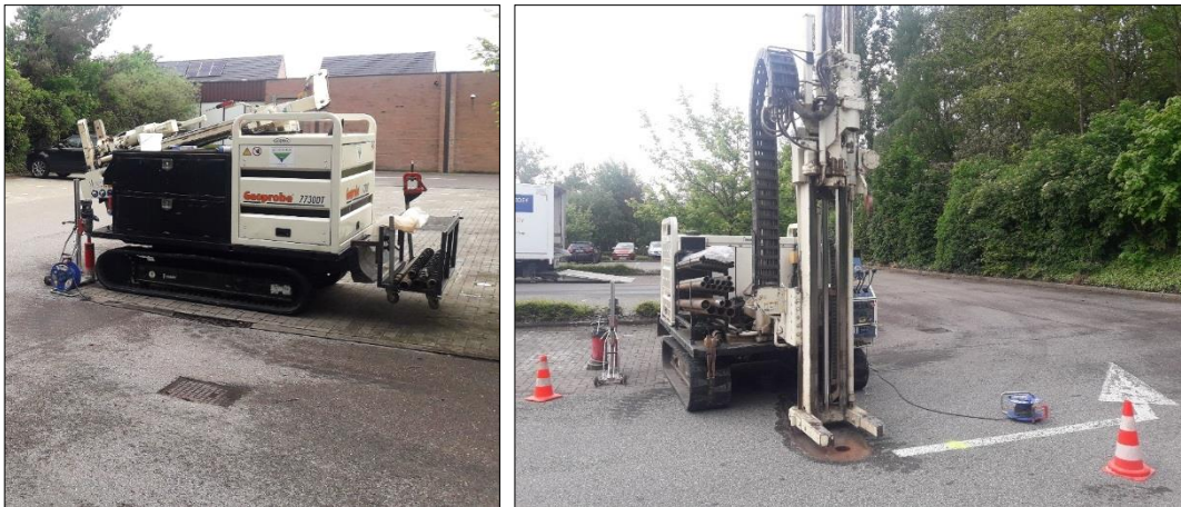
Figuur 2: Uitvoering van de mechanische boringen door Geosonda nv met een Geoprobe 7730DT.
