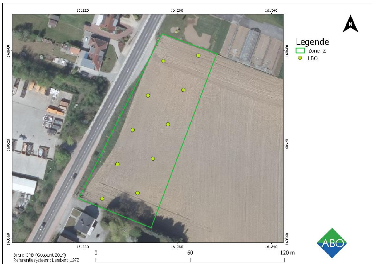
Figuur 3: Luchtfoto 2018 met aanduiding van de boorpunten voor het landschappelijk bodemonderzoek op het terrein voor grondverbetering (Geopunt 2019)
