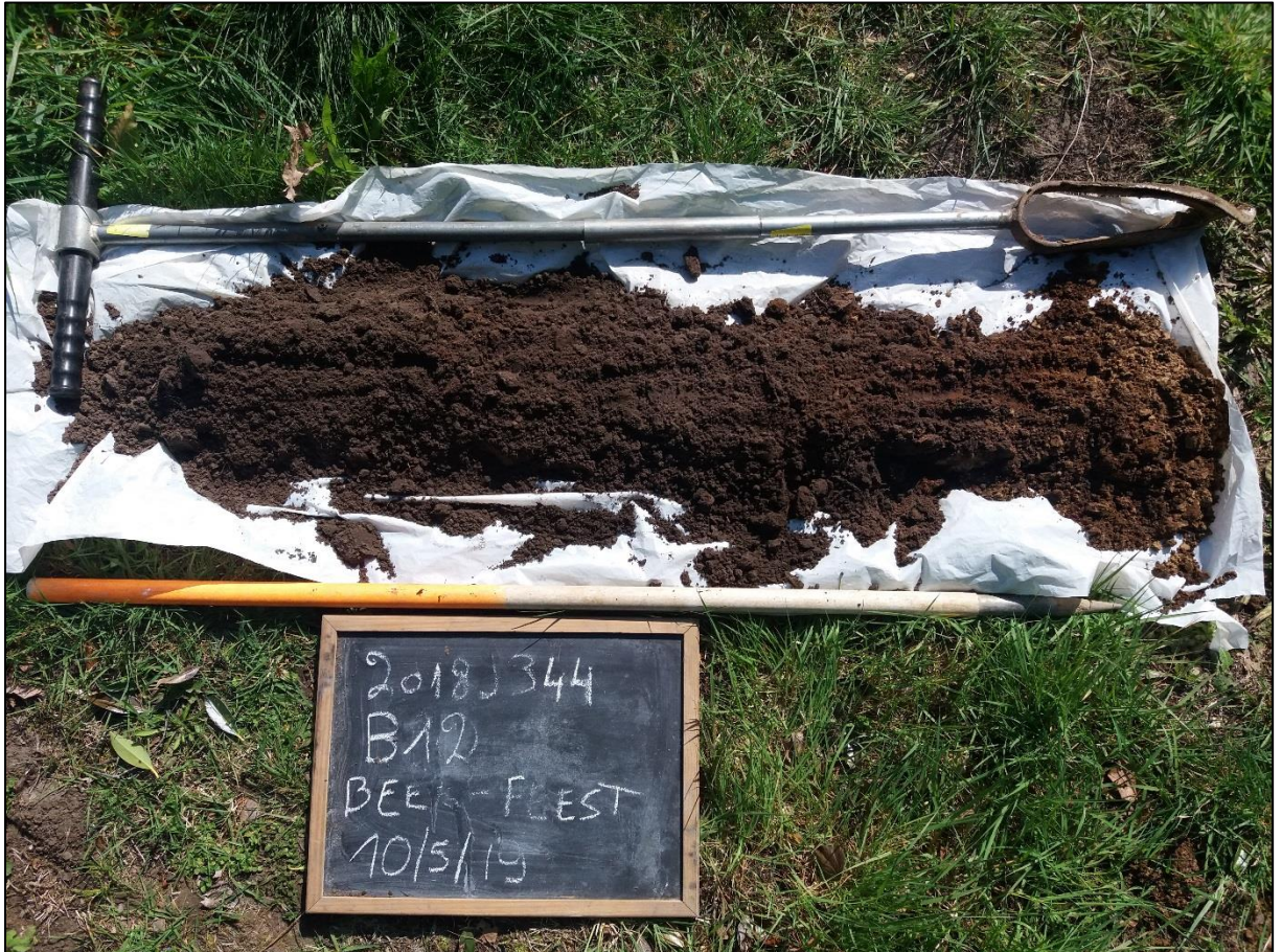
Figuur 57: Foto van boring 12 (ABO nv 2019)
