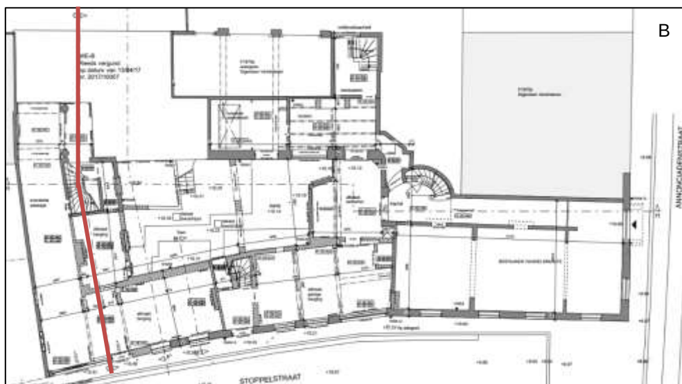
Figuur 2: (A) Profielsnede bestaande toestand C-C'; (B) Lokalisering proefielsnede C-C' op gronpland bestaande toestand gelijkvloers. 13
