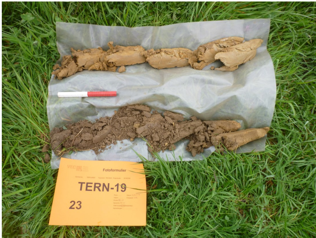
Afb. 8. Boring 23, uitgelegd van links naar rechts en van onder naar boven.
