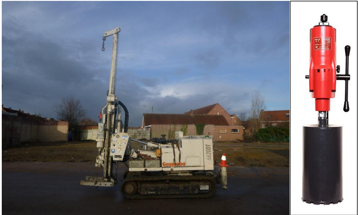
Figuur 25: Overzicht van gebruikte boren. Links: Geoprobe boormachine; rechts: kernboor.
