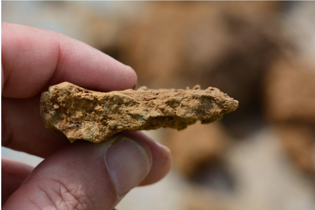
Figuur 26: Voorbeeld van plaatstructuur uit horizont BE in P-01. Deze is een indicatie van sterke compactatie.
