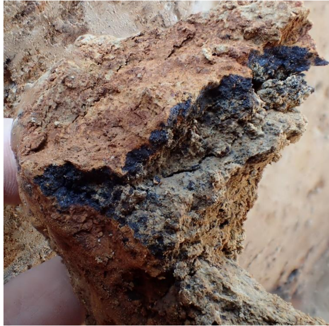
Figuur 28: Detail van een “Placic horizon” (Btm), een ondoordringbare laag van gecementeerd ijzer en mangaan
