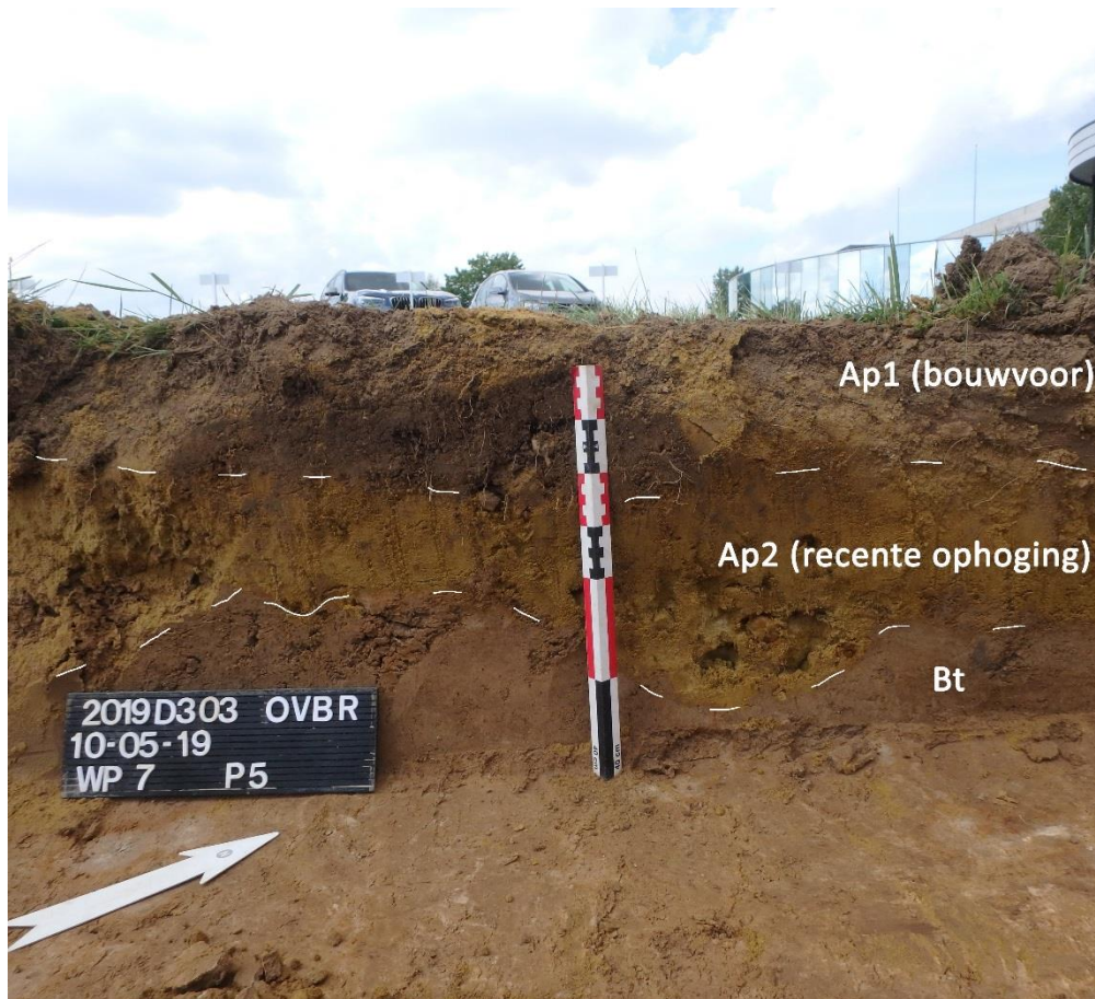
Figuur 34: Profiel P-05 met onder de donkerbruine bouwvoor sporen van een recente afgraving waarna het terrein opgehoogd werd met geel zand. Hieronder bevindt zich de Bt horizont.
