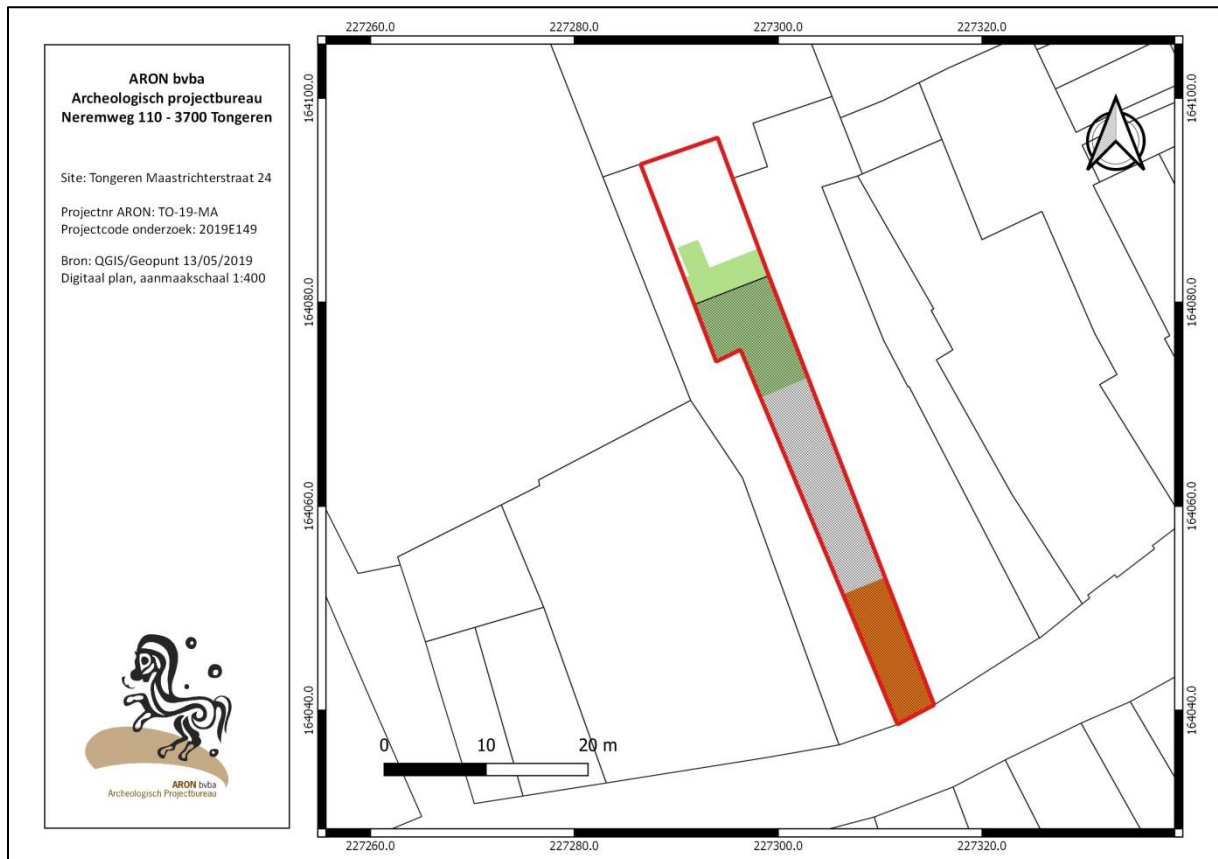
Afb. 33: Vereenvoudigd kadastraal plan met aanduiding van het projectgebied (rode polygoon), de zone waar vloeren worden uitgebroken (grijze polygoon), de zone waar het vloerpeil wordt verhoogd (groene polygoon) en ten slotte het reeds onderkelderde gedeelte van de woning (oranje polygoon).
