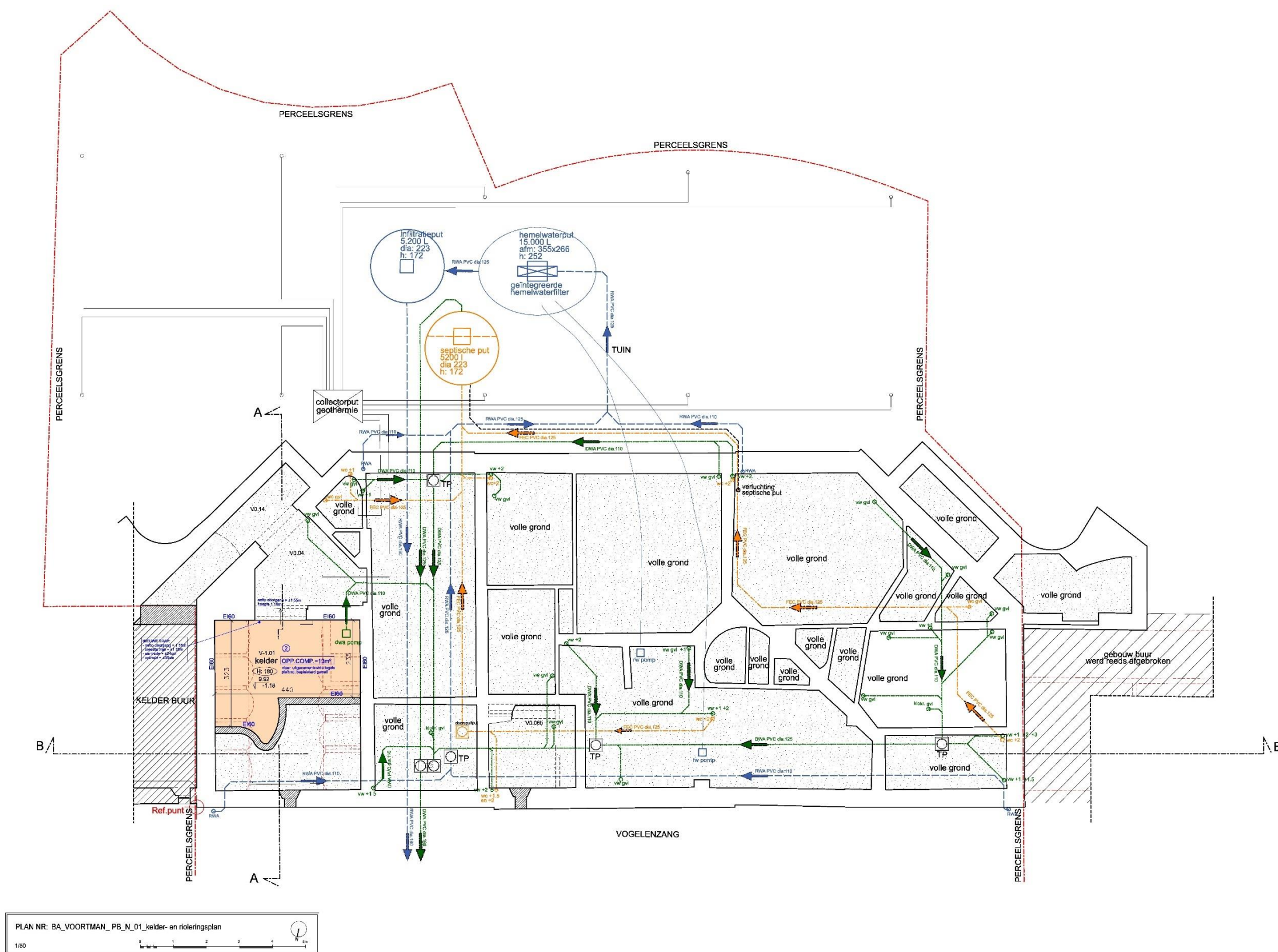
Figuur 14: Kelder- en rioleringsplan (...
