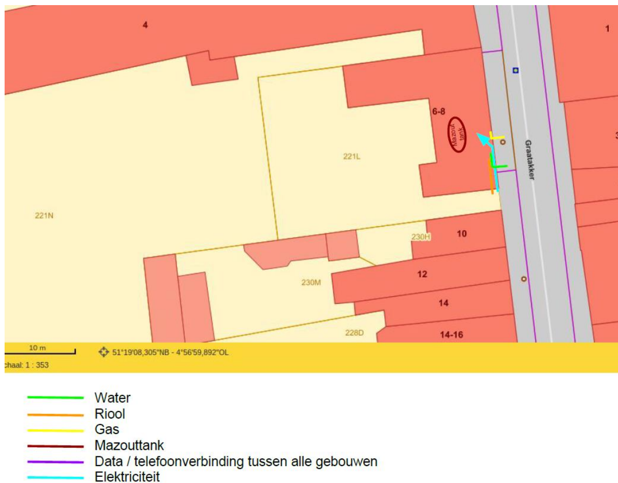
Figuur 34: Ondergrondse nutsvoorzieningen Graatakker 6-8 22
