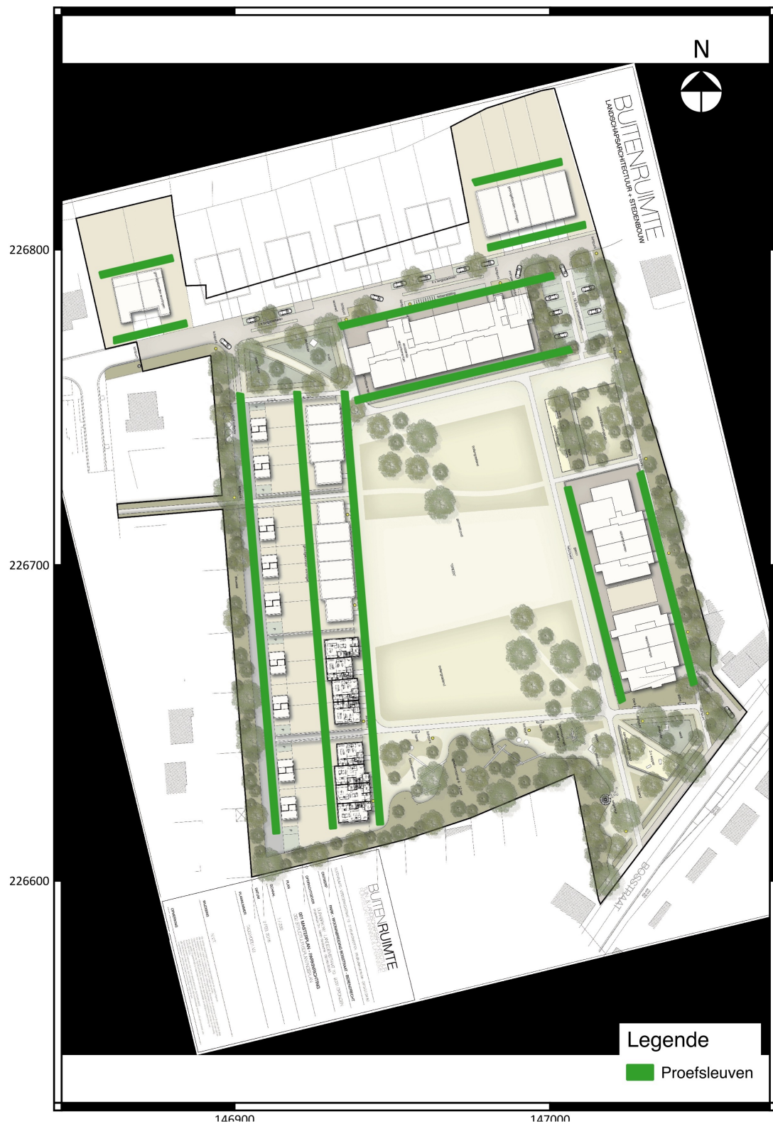
Fig. 2.3: Voorstel voor de aanleg van proefsleuven.
