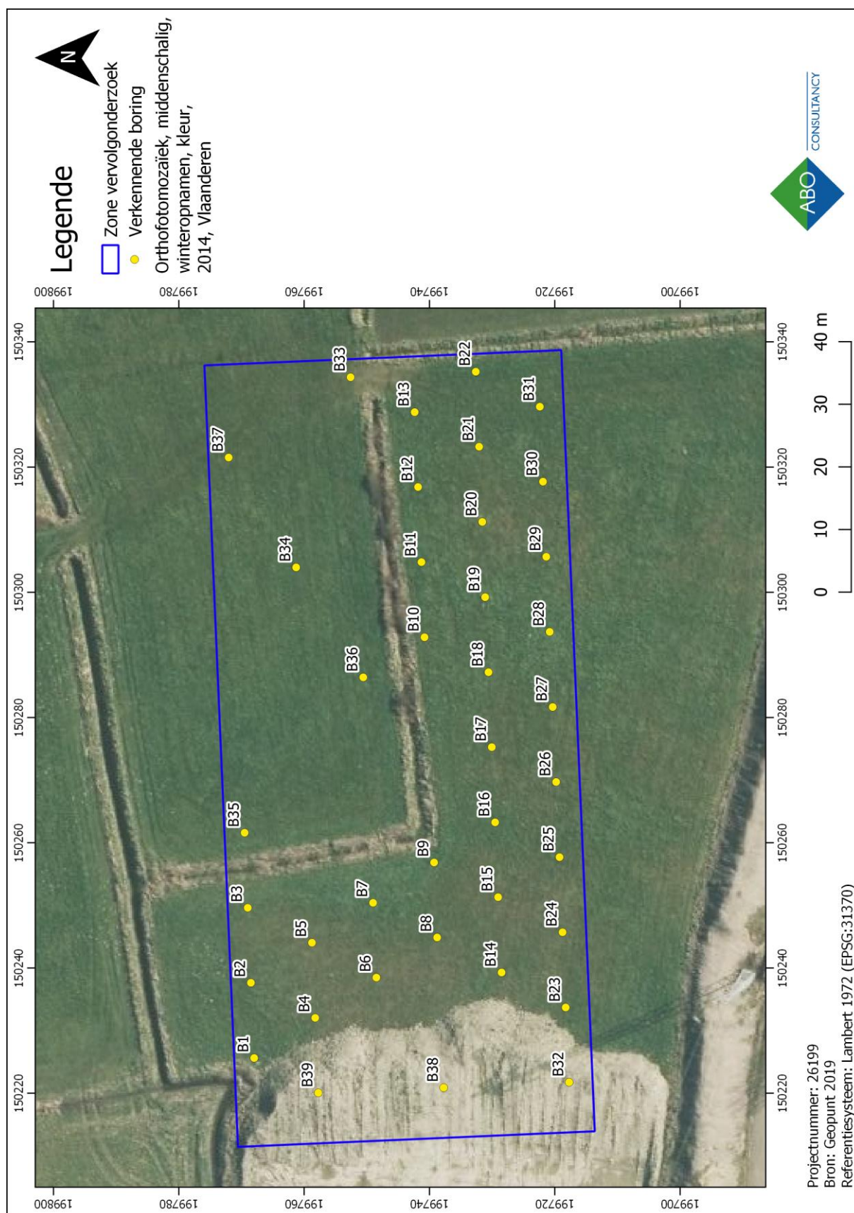
Figuur 7: Ortholuchtfoto uit 2014 met aanduiding van de uitgevoerde verkennende boringen
