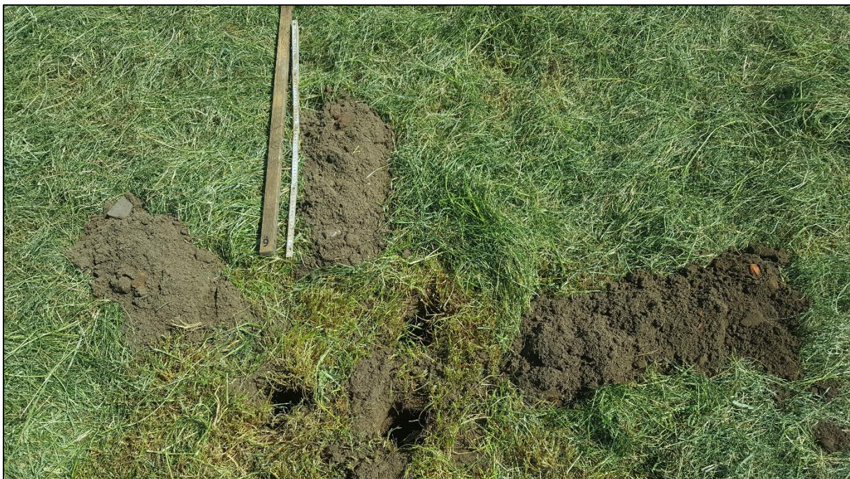
Figuur 14: Boring 6 toont een voorbeeld van een gestaakte boring (ABO nv 2019)
