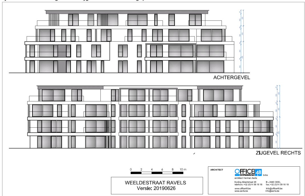
Afb. 15. De achtergevel en de zijgevel rechts van de geplande werken.
