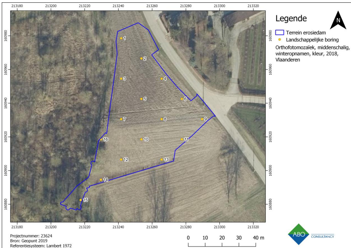
Figuur 2: Luchtfoto (middenschalige winteropnamen, kleur, 2018) met aanduiding van de boorpunten voor het landschappelijk bodemonderzoek t.h.v. het terrein voor grondverbetering met bufferbekken (boven) en het terrein voor de erosiedam (onder)
