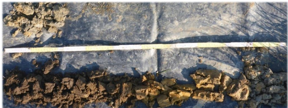
Figuur 19: Boring B7 (met alluviale afzettingen) waarin een granulaire grens zichtbaar is als gevolg van afgedekte kleilig sediment onder het dekzand.
