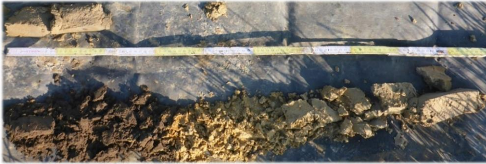
Figuur 21: Boring B6 met een A-C-profiel
