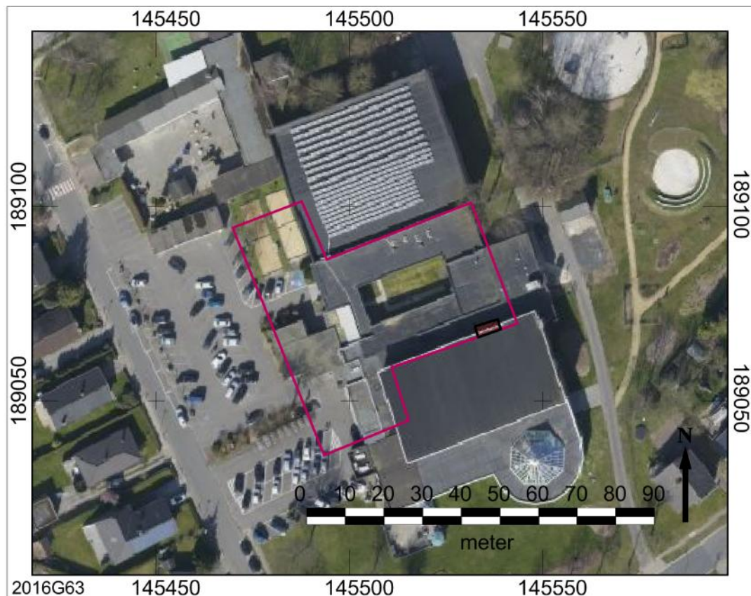
Afbeelding 1: Synthesekaart met de huidige verstoringen. Het plangebied wordt weergegeven met het paarse kader. De aanwezige bebouwing komt duidelijk naar voren op deze luchtfoto. De gehele bebouwing is gebouwd op vloerplaat. Of de vloerplaat ondersteund wordt door funderingszolen, funderingssleuven of palen is niet bekend. In het zuidoosten is een kleine zone (20 m 2 ) gelegen die onderkelderd is (zwart kader met rode arcering).
