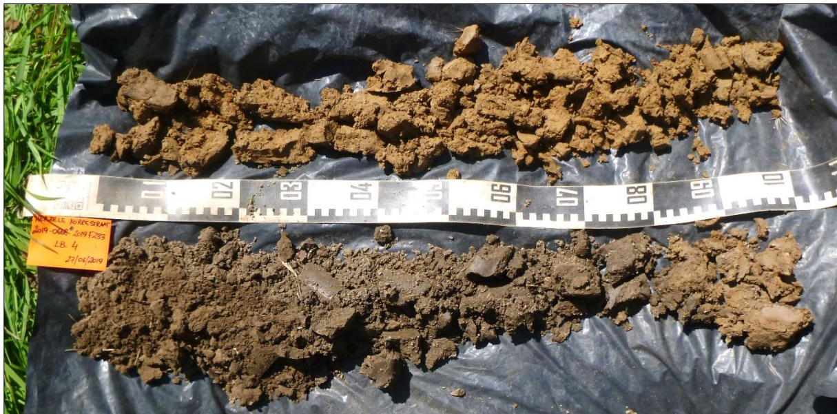
Figuur 8: Boring 4 van 0 cm links beneden tot 200 cm rechts boven
