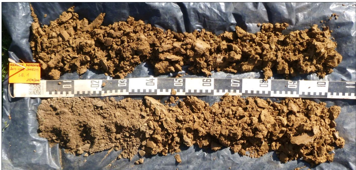
Figuur 5: Boring 1 van 0 cm links beneden tot 200 cm rechts boven
