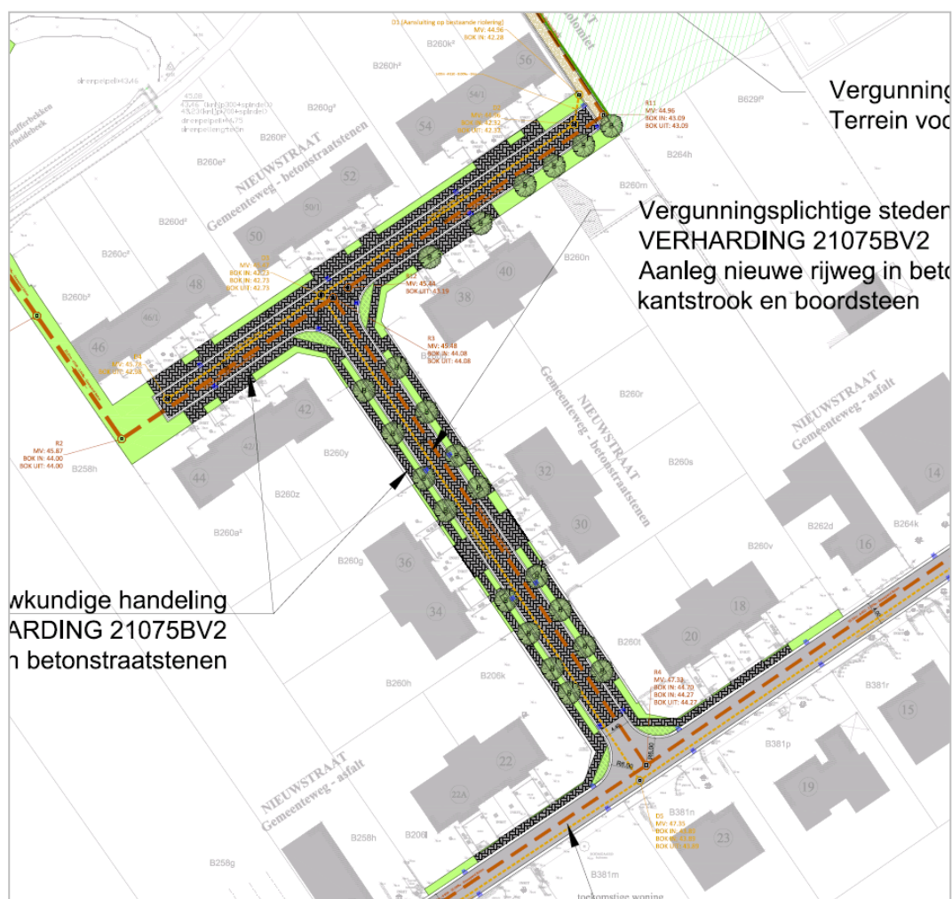
Afb. 18. Grondplan met locatie van het rioleringsstelsel zone 2 (Donkerbruin: RWA en lichtbruin: DWA).
