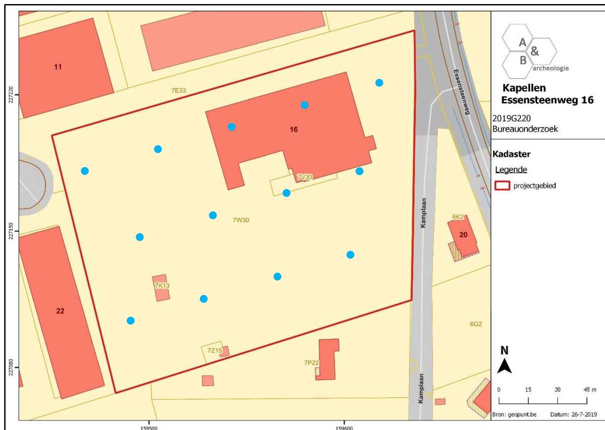
Figuur 2 Aanduiding van de boorpunten (blauwe stippen) voor het landschappelijk bodemonderzoek binnen het plangebied, geprojecteerd op het kadasterplan (bron: geopunt.be).
