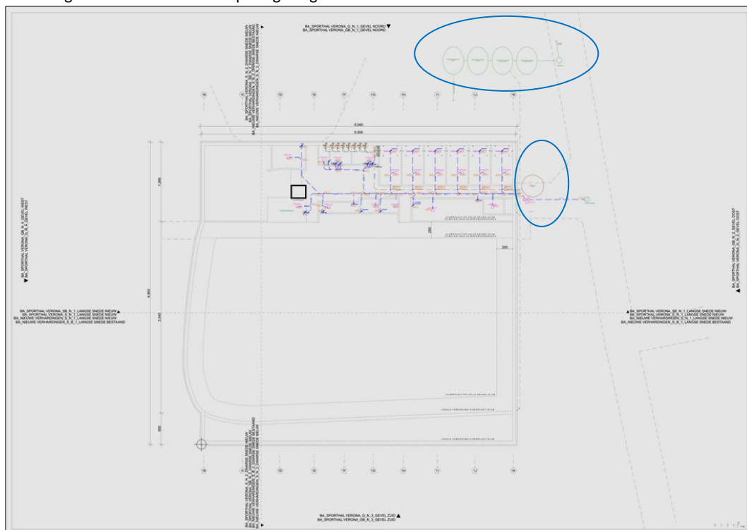
Afb. 10. Niveau -2 van de nieuwbouw met aanduiding van de putten en riolering (blauw).
