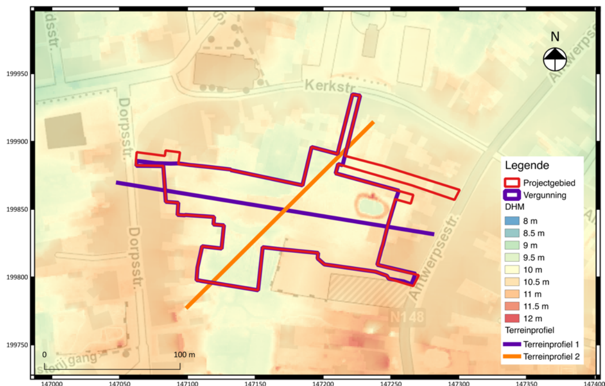
Fig. 1.10: Detail uit het digitaal hoogtemodel (DHM II) met aanduiding van de terreinprofielen.
