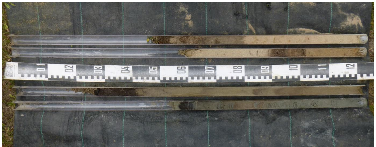
Figuur 35: Overzichtsfoto van boring BP2, uitgelegd van boven naar onder en van links naar rechts.
