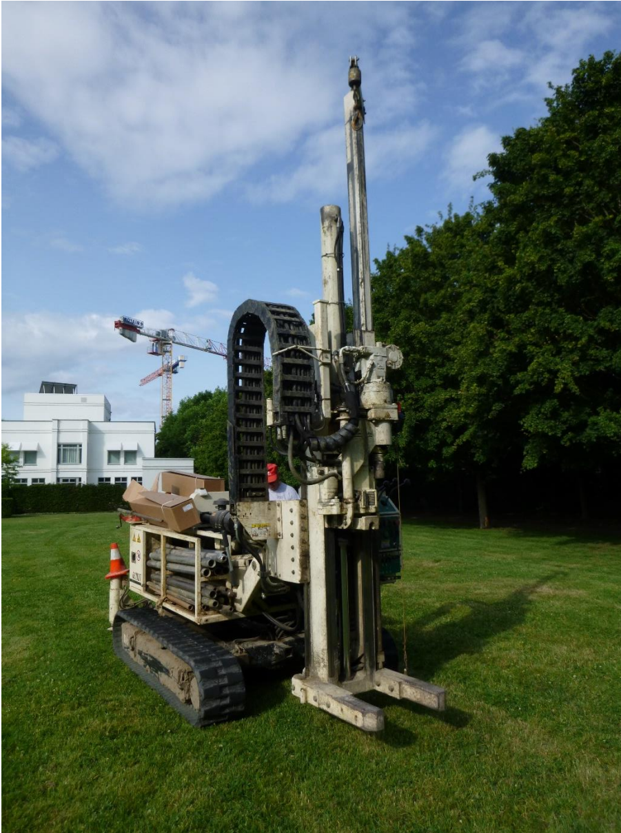
Figuur 40: Foto van een gelijkaardige Geoprobe boormachine als die gebruikt tijdens dit booronderzoek.
